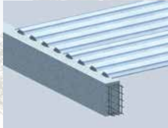
Pemasangan diatas balok beton
